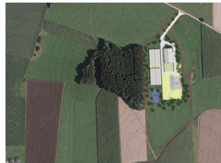
Die Abbildung zeigt einen Entwurfsplan für den Bohrplatz sowie das spätere Kraftwerk. Hierbei ist darauf hinzuweisen, dass sich je nach Kraftwerkslieferant und der Fündigkeit der Bohrungen Modifikationen der einzelnen Kraftwerksbestandteile ergeben können, die zum jetzigen Zeitpunkt noch nicht absehbar sind. Für die Planung wurden die maximalen Maße zugrunde gelegt.
